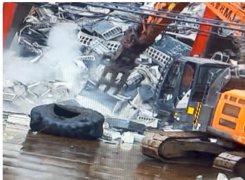
金属スクラップヤードにおいて みだり放出されるフロン類
