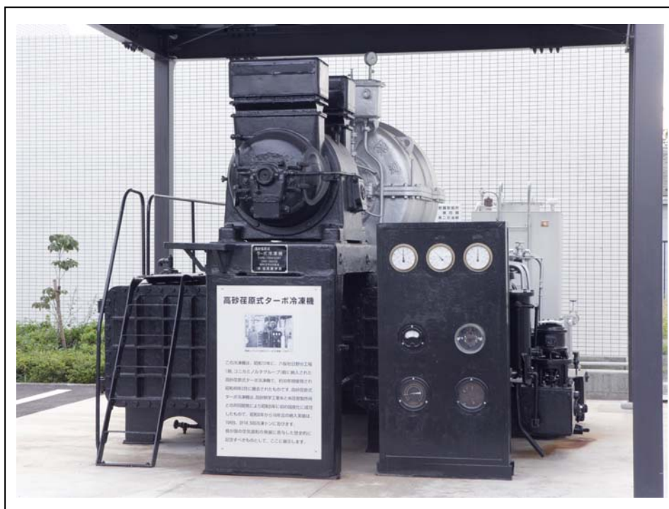
写真 - 1 「機械遺産」に認定された現存する最古の国産ターボ冷凍機
