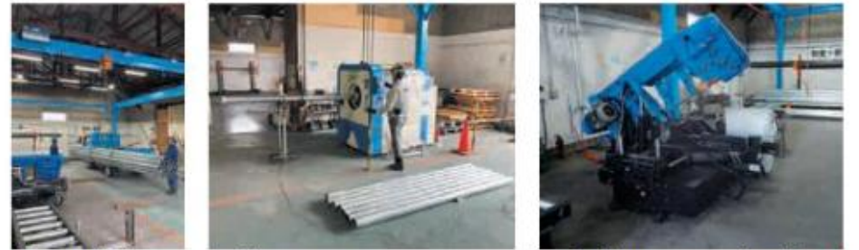
施設の稼働状況 配管フレア加工 全自動バンドソー（配管切断機）
